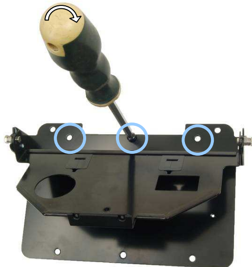
Obrázok 1 – upevnenie pántu na sedačku pomocou skrutiek
