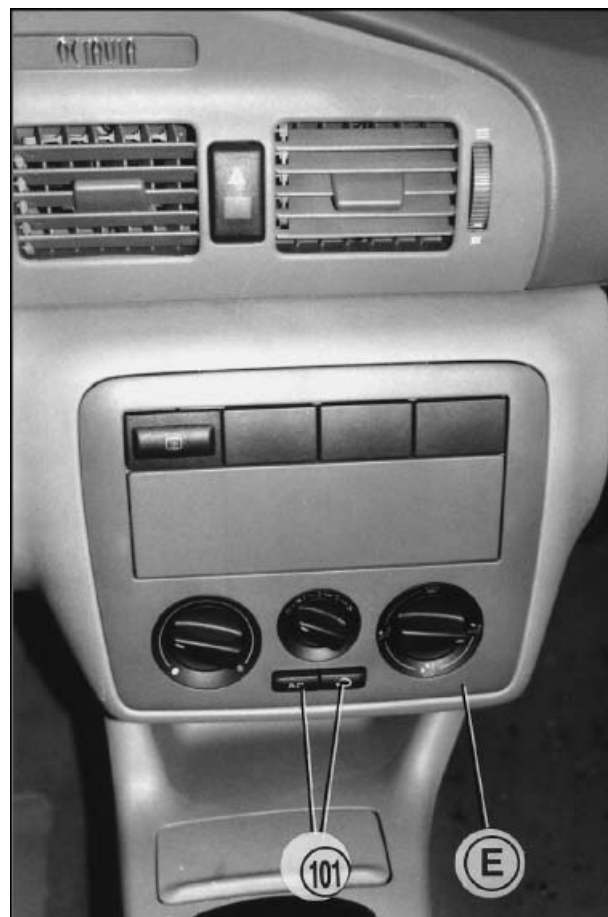
obr. 39 – Rám “E” zabudovat do původní pozice. Všechny původní díly vymontované z vnitřního prostoru vozu opět zabudovat.
