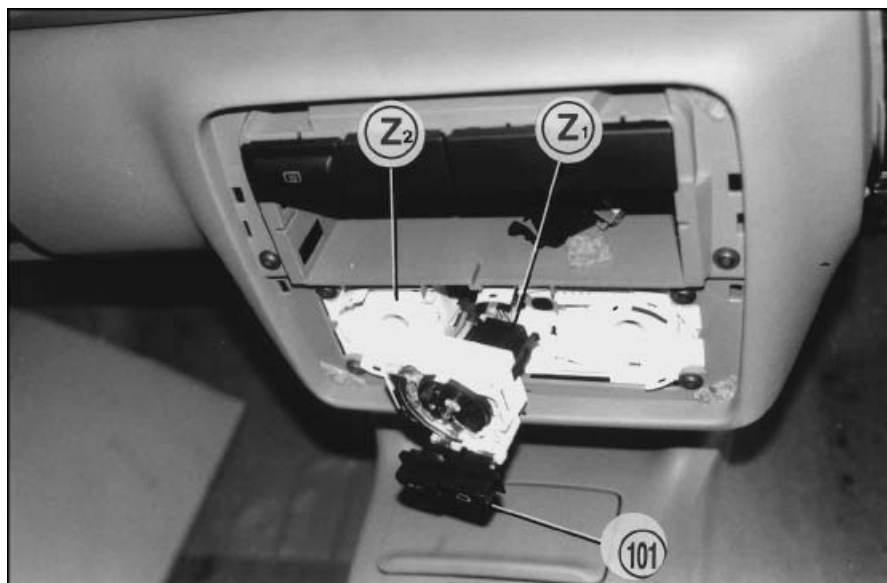
obr. 37 – Konektory “Z1” a “Z2” napojit na vypínač ovládání “101” (viz. schéma zapojení, pozice 2).
